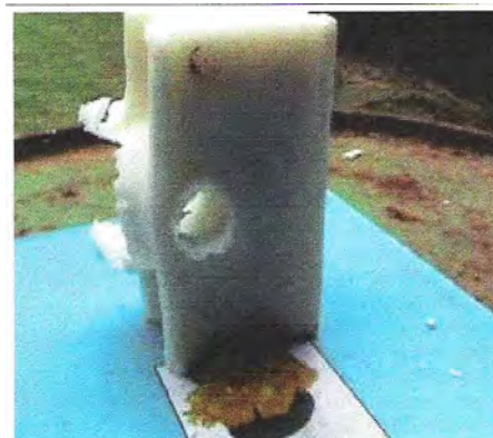
DISPARO SOBRE PARAFINA REALIZADO EN EL LABORATORIO DE BALISTICA (ver expansión, orificios de entrada y salida)
