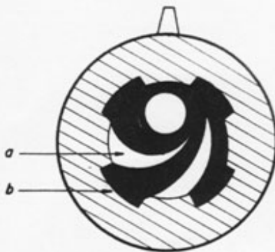
ASPECTO DEL ANIMA DE UN ARMA CON RAYADO HACIA LA IZQUIERDA: a. CAMPOS, b. ESTRIAS
